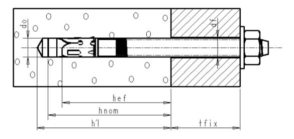
$h_{\text{ef}}$ : effective anchorage depth  $h_{\text{nom}}$ : embedment depth  $h_{1}$ : drilling hole depth  $t_{\text{fix}}$ : fixture thickness
